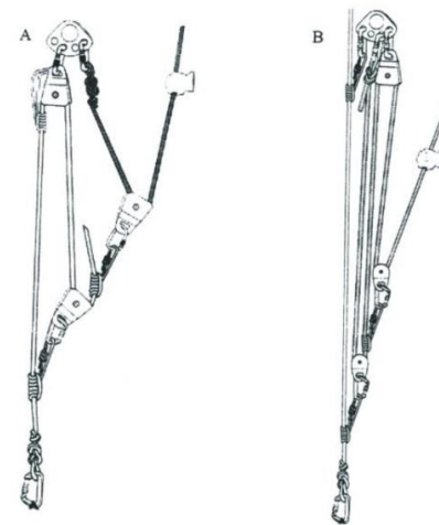
А - Сложный полиспаст 6:1 Полиспаст 2:1 тянет полиспаст 3:1 В этом случае требуется перестановка двух схватывающих узлов.
