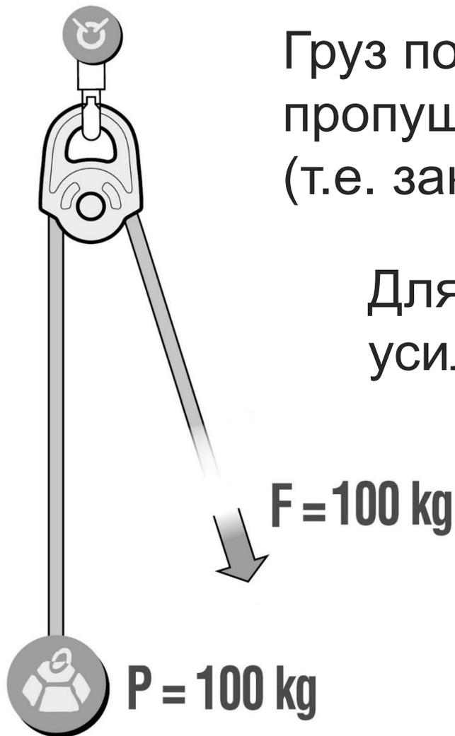
Для поднятия груза на высоту 1 метр необходимо протянуть через ролик 1 метр веревки.
